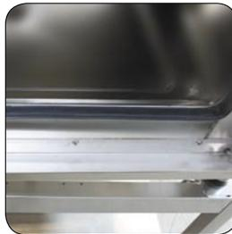
**Raccogli condensa acqua** raccoglie l'acqua di condensa del vetro che viene automaticamente versata nella canalina di scarico evitando così fastidiosi gocciolii sul pavimento della cucina.
