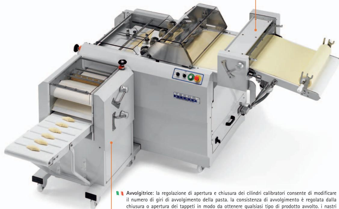
**IT** Avvolgitrice: la regolazione di apertura e chiusura dei cilindri calibratori consente di modificare il numero di giri di avvolgimento della pasta. la consistenza di avvolgimento è regolata dalla chiusura o apertura dei tappeti in modo da ottenere qualsiasi tipo di prodotto avvolto. i nastri avvolgitori sono facilmente sostituibili per un rapido intervento di pulizia.
